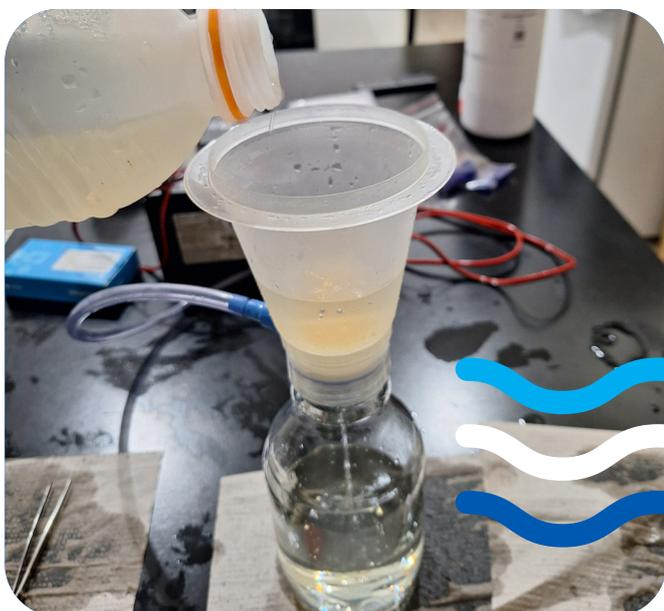
*Filtragem em laboratório das amostras de água obtida no campo*
